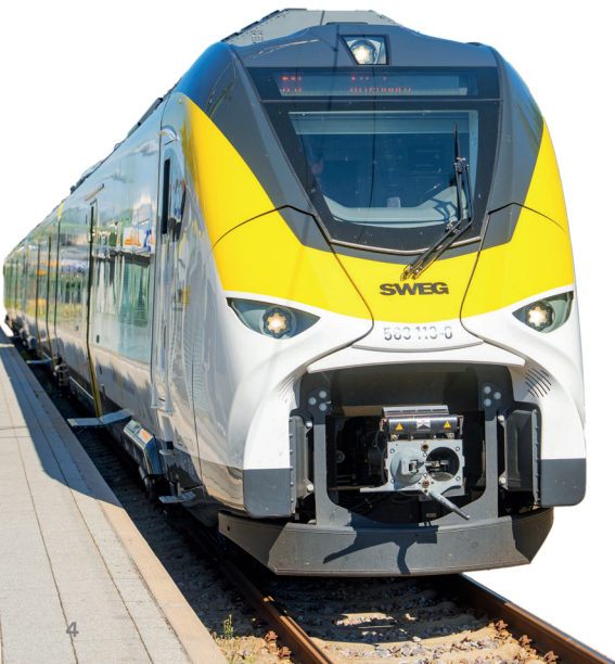
Damals und heute: Statt dieselgetriebener Schienenbusse fahren nun batterieelektrische Triebzüge der Baureihe Siemens Mireo
